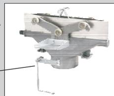
Дроссельная заслонка не является выключателем разрежения в системе, а служит для повышения эффективности системы и снижает требования к производительности вентилятора!
